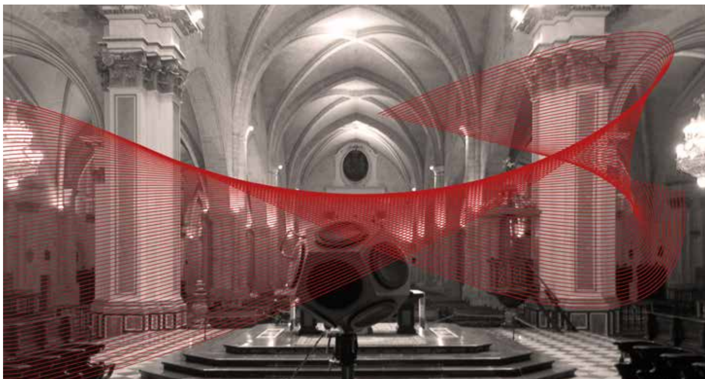
Medición acústica de la Catedral de Valencia. Fuente: Autores / Acoustic measurement of the Cathedral of Valencia. Source: Authors
