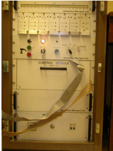
Figura 4: Controlador Mark II del PUMA-560. En el módulo de control se disponen las nuevas tarjetas de interfase con el PC a través de la tarjeta de adquisición Q8.
