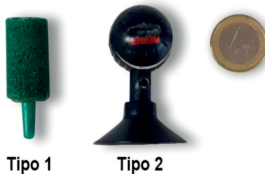
Figura 3 | Imagen del tamaño y forma de los difusores Tipo 1 y Tipo 2 empleados en la parte experimental de laboratorio de este estudio.
